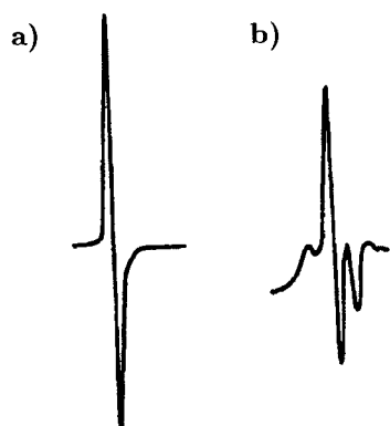
Rys. 2. Widmo EPR celulozy starzonej termicznie (a) i pod wpływem wyladowań niezupełnych (b) [10]
