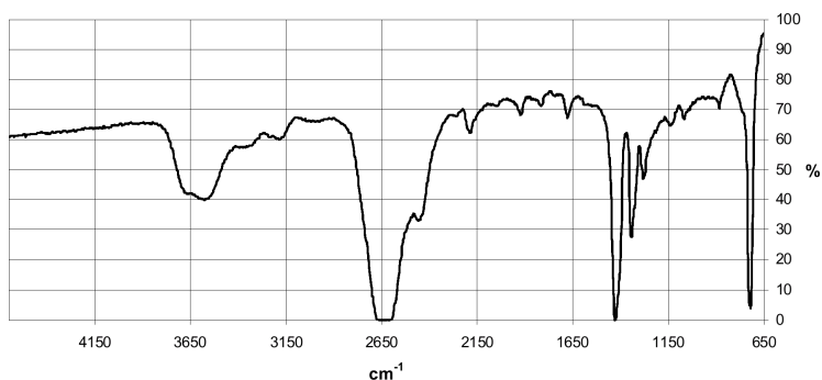
Rys. 3. Spektrogram izolacji PE kabla uszkodzonego podczas eksploatacji
