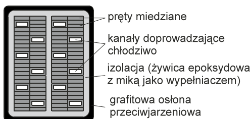
Rys. 2. Budowa pręta uzwojenia generatora synchronicznego
