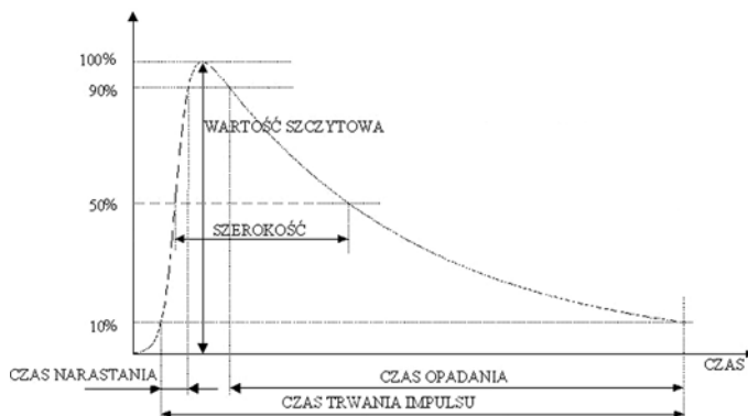
Rys. 4. Parametry charakteryzujące kształt impulsu prądowego
