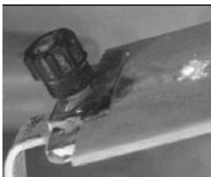
Rys. 9. Erozja materiału przy elektrodzie uziemionej
