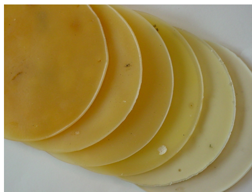
Rys. 6. Przykład przebarwienia próbek z tworzywa silikonowego badanych w atmosferze tlenków azotu
