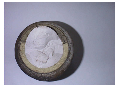
Rys. 2. Przełam izolatora długopniowego
