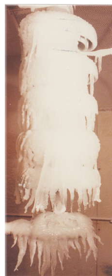
Rysunek 5. Łańcuch izolatorów standardowych IEEE pokryty warstwą lodu "mokrego" o grubości 2 cm (zdjęcie wykonane przez autora w laboratorium GRIEA)
