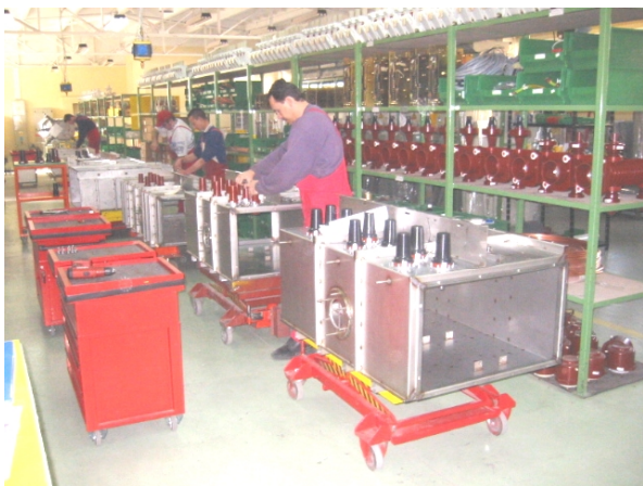
Rys. 1. Produkcja rozdzielnic TPM w izolacji gazowej.
