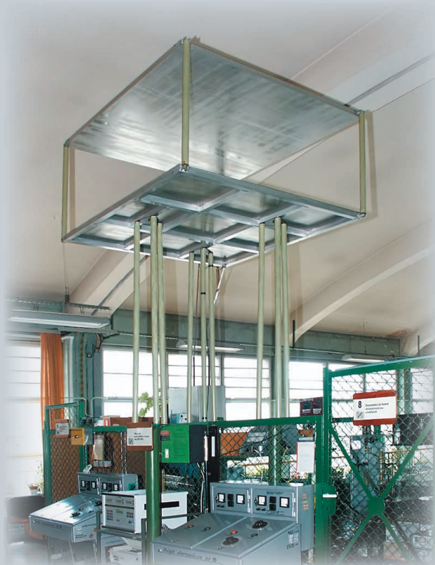
Wzorzec pola elektrycznego 50Hz (KEE AGH)
