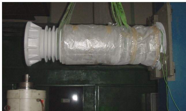
Rys. 4. Izolator osłonowy zamontowany na stanowisku badawczym tuż przed rozpoczęciem próby (po wyjęciu z komory zamrażania)
