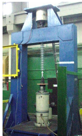
Rys. 1. Widok stanowiska badawczego z zamontowanym do prób izolatorem kompozytowym do linii 110 kV
