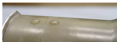
Rys. 5. Matowy pas powstały wskutek stabilnych niepełnych wyładowań powierzchniowych
