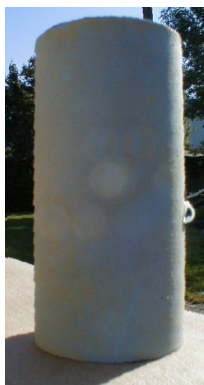
Rys. 5. Kropla wody na hydrofobowej warstwie na kuczuku silikonowym
