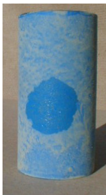
Rys. 4. Ślad po kropli wody na warstwie Bentonitu na izolatorze epoksydowym
