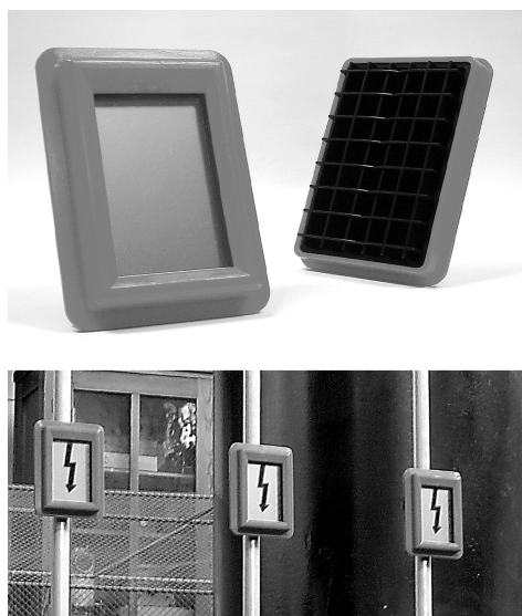
Rys. 3. Prototypy wskaźnika napięcia wykonane w oparciu o technologię wyświetlaczy ciekłokrystalicznych
