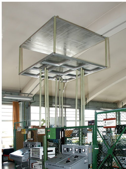
Rys. 3. Wzorzec pola elektrycznego w Katedrze Elektroenergetyki AGH według wymagań normy PN-IEC 833:1997
