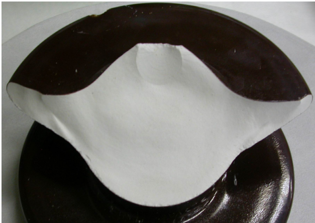
Rys. 5. Obraz przełamu izolatora LPa
