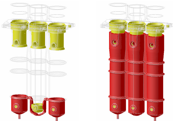
Rys.5. Wypełnianie wnętrza formy
