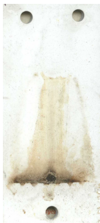
Fot. 2. Wygląd próbki po wykonaniu badania odporności na prądy pełzające.
