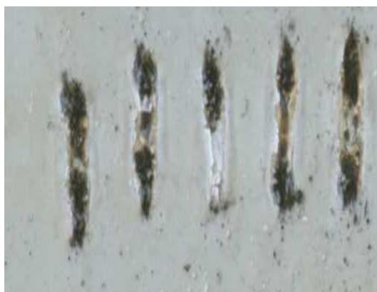
Fot. 3. Wygląd fragmentu próbki po wykonaniu badania odporności na łuk elektryczny
