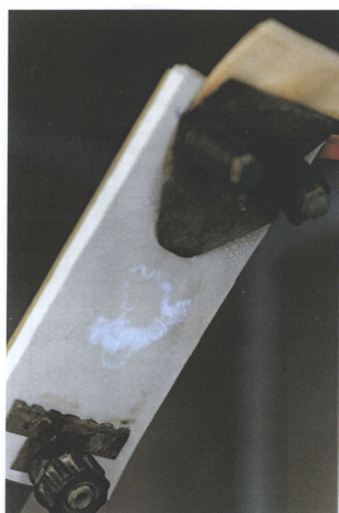
Fot. 1. Próbką pokrycia silikonowego na płytce z porcelany elektrotechnicznej z elektrodami podczas trwania badania odporności na prądy pełzające.
