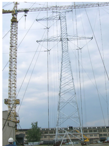
Rys. 2. Sylwetka słupa przelotowego P I+10 – na stacji prób
