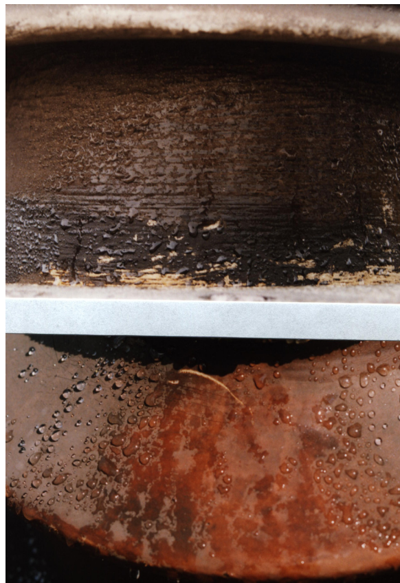
Rys.1. Utrata hydrofobowości izolatorów w miejscach zanieczyszczonych olejem
