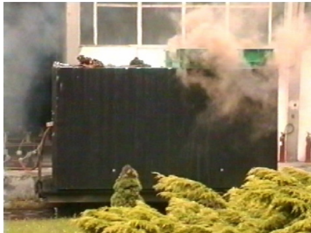
Rys. 14. Badania stacji podziemnej w Instytucie Energetyki wg norm IEC, w szczególności łukoochronność korytarza obsługi.
