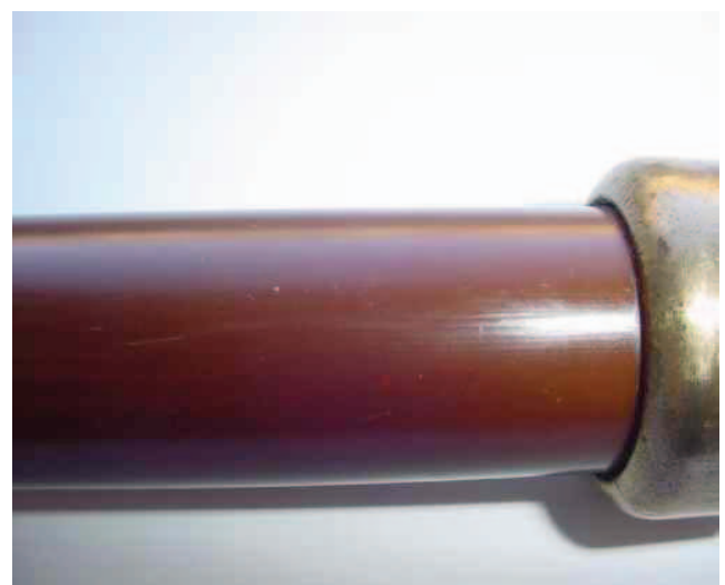
Rys. 9. Powierzchnia izolatora starzonego w komorze mgły solnej oraz izolatora nowego
