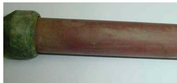
Rys. 10. Powierzchnia izolatora po 38 miesiącach starzenia na stanowisku terenowym w klimacie nadmorskim. Po prawej stronie widoczne zmiany na powierzchni izolatora.
