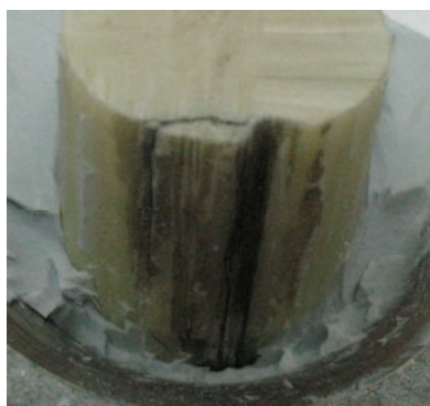
Rys. 4. Izolator z pozycji 2), przebit podczas prób stromym udarem napięciowym
