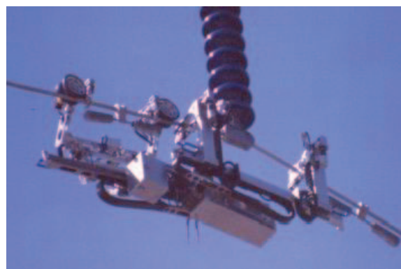
Rys.5. Pokonywanie przeszkody przez robota w technologii LineScout na linii pod napięciem 315 kV [4]
