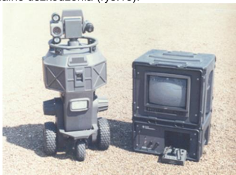
Rys.13 Robot do inspekcji urządzeń stacyjnych [12]
