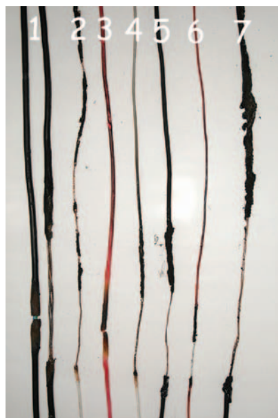
Rys.2. Wybrane próbki przewodów po spalaniu
