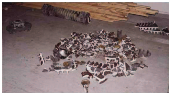
Rys. 1. Rezultat eksplozji porcelanowej obudowy ogranicznika
