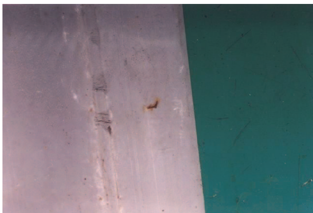
Rys. 6. Wpływ wilgoci na zmiany strukturalne przewodnicy kauczukowej
