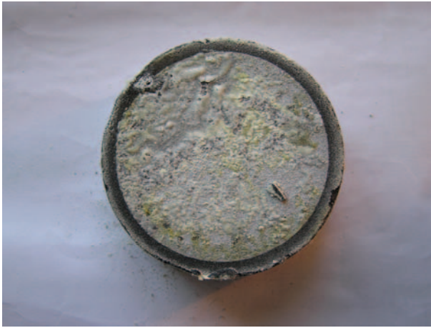
Rys.1. Wpływ wilgoci na zmiany strukturalne warystora SiC
