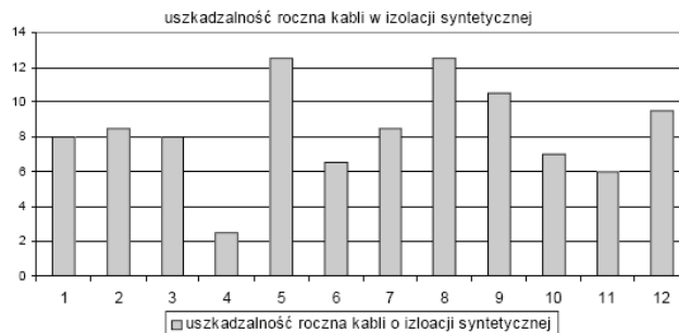
Rys.6. Roczna częstość (%) występowania uszkodzeń kabli o izolacji polietylenowej (XLPE) [8]
