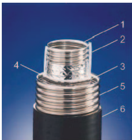
Rys.6. Osłona termiczna kabla z cold-dielektrykiem ; 1- karbowana rura wewnętrzna, 2- odstępnik, 3- odstęp próżniowy, 4- izolacja wielowarstwowa, 5- karbowana rura zewnętrzna, 6-osłona PE [4]
