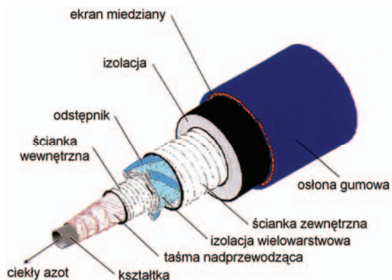
Rys. 4. Kabel nadprzewodzący firmy NKT Dania [5]
