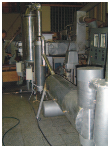
Rys.6. Laboracyjne stanowisko badawcze do utylizacji odpadów żywicznych
