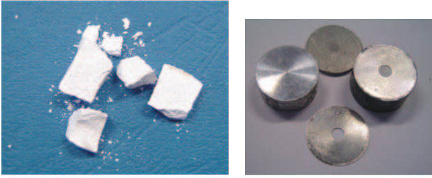
Rys.7. Produkty odzyskane z ograniczników przepięć (poprawnie zdefiniowane parametry procesu)
