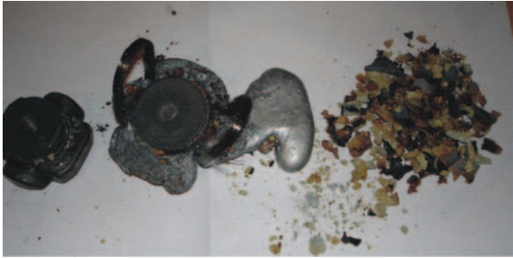
Rys.8. Produkty odzyskane z ograniczników przepięć (błędnie zdefiniowane parametry procesu)
