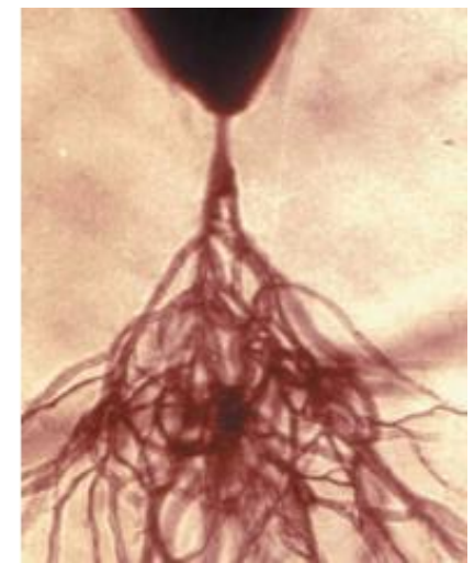
Próba igłowa w PE
